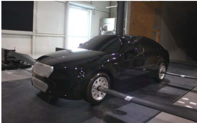
Figure 12. The DrivAer model in the Technische Universität München wind tunnel A .
